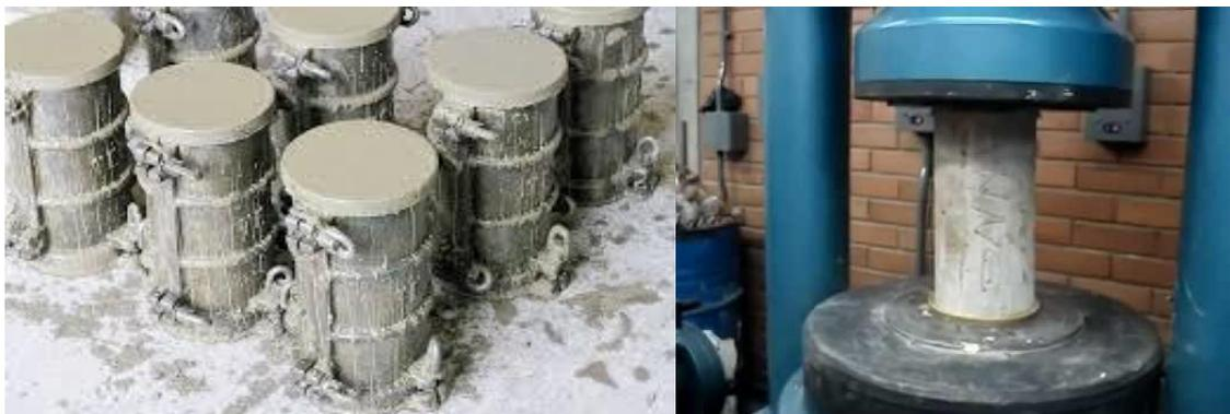
Foto 2 - Teste de compressão do concreto.
