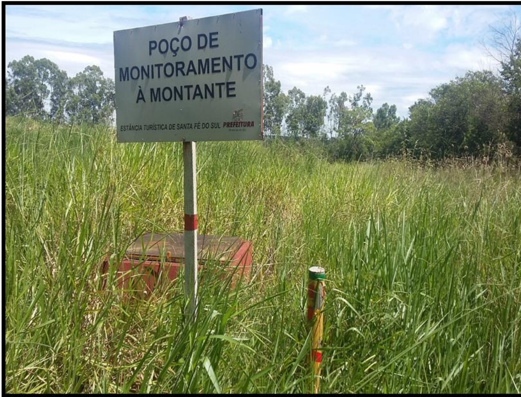
Imagem 85 – Poço de Monitoramento no Aterro Sanitário
